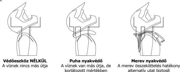
22. ábra – Terhelésátviteli példája hátrahajlított fej esetében.
