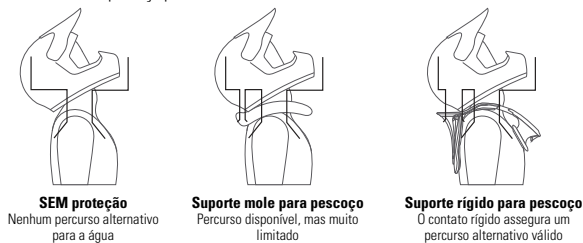
Figura 22 – Analogias da transferência de carga com a cabeça dobrada para trás.
