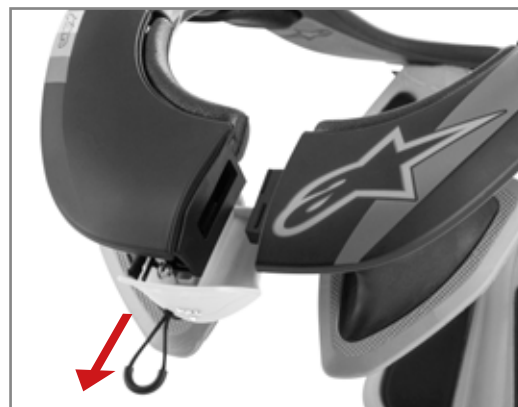
2. ábra – Gyorsan kiakasztható bekapcsoló rendszer: gyorsan és ügyesen lehet alkalmazni, illetve eltávolítani, melynek köszönhetően rendkívül könnyű és biztonságos a nyaktvédő bekapcsolása, amit vészhelyzet esetén nagyon gyorsan szét lehet nyitni.
