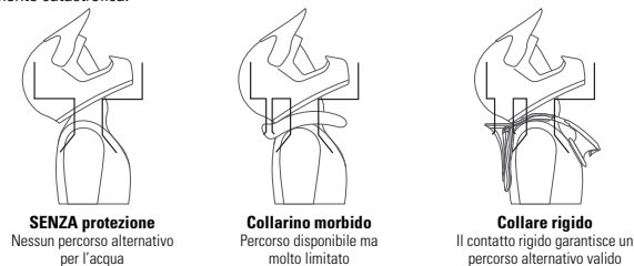
Figura 22 – Analogie del trasferimento di carico con la testa piegata all'indietro.
