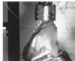
Obrázok 18 – Fotografia nárazu urobenej pri 32 a 90ms ukazujúca flexiu a extenziu (NORMÁLNY rozsah).
