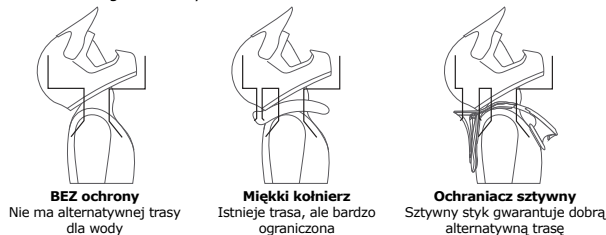
Rysunek 22 – Analogia przeniesienia obciążenia, gdy głowa odgięta jest do tyłu.
