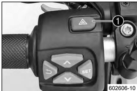
Spínač varovných světel ❶ je umístěn na kombinovaném spínači vlevo. Varovná světla se používají k označení nouzových situací.
