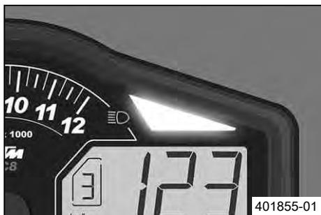
Indikátor řazení bliká nebo svítí, pokud se má provést řazení rychlostního stupně. V menu **"Shift Light"** lze nastavit otáčky pro indikátor řazení. Při otáčkách vyšších než **"RPM1"** indikátor řazení bliká a při otáčkách vyšších než **"RPM2"** svítí.
