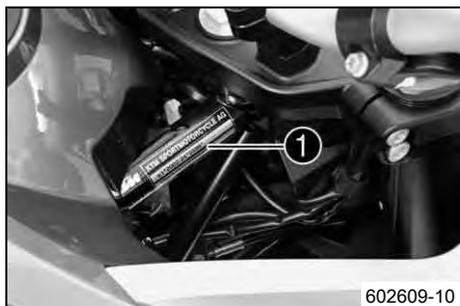
Typový štítek **1** je umístěn na rámu vpravo nahoře za hlavou řízení.
