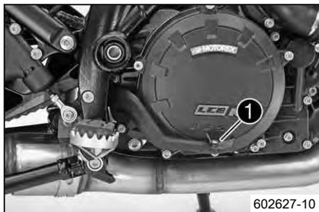
Nožní brzda ① se nachází před pravou stupačkou. Pedálem nožní brzdy se ovládá brzda zadního kola.
