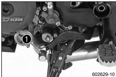
Řadicí páka ❶ je umístěna na motoru vlevo.
