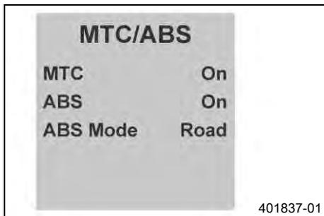
Kontrola trakce snižuje točivý moment při ztrátě trakce zadního kola. V závislosti na nastavení kontroly trakce může být rovněž žádoucí malý prokluz zadního kola. Příklad: Offroad.
