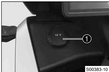
Zásuvka **1** pro elektrické příslušenství je umístěna vlevo vedle sdruženého přístroje na palubní desce.
