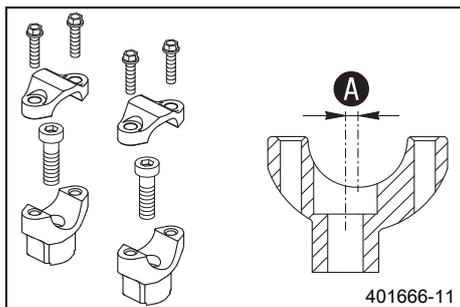
Otvory vyvrtané na úchytu řídítek jsou umístěny ve vzdálenosti **A** ze středu.
