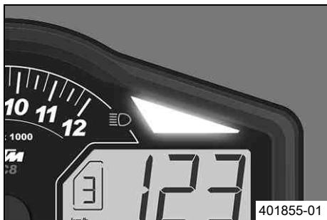
Indikátor řazení bliká nebo svítí, pokud se má provést řazení rychlostního stupně. V menu "**Shift Light**" lze nastavit otáčky pro indikátor řazení. Při otáčkách "**RMP1**" indikátor řazení bliká a při otáčkách "**RPM2**" svítí.
