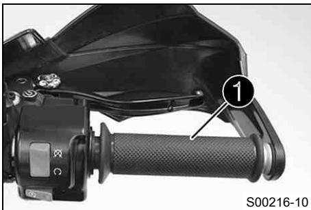
Otočná rukojeť plynu **1** je umístěna na řídítkách vpravo.
