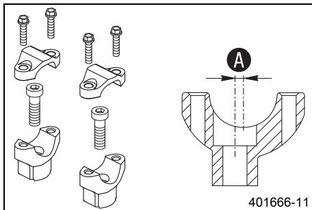
Otvory vyvrstané na úchytu řídítek jsou umístěny ve vzdálenosti **A** ze středu.
