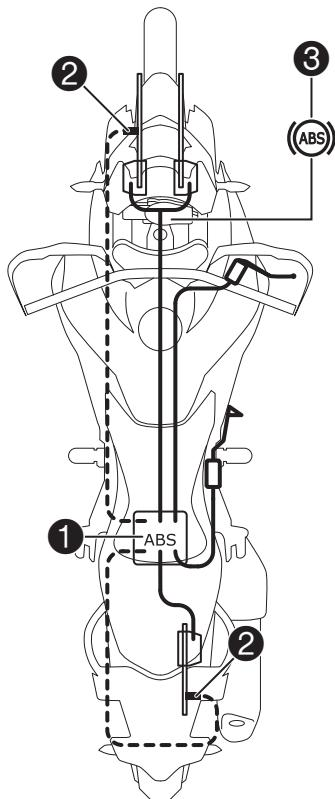
Jednotka ABS ① se skládá z hydraulické jednotky, řídící jednotky ABS a zpětného čerpadla, a je namontovaná pod sedačkou. U předního a zadního kola je vždy jeden snímač otáček kola ②.
