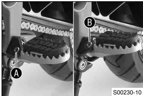
Stupačky řidiče lze namontovat do dvou různých poloh.
