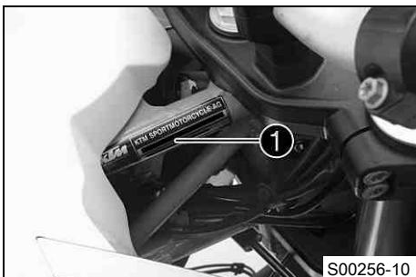
Typový štítek ① je umístěn na rámu vpravo nahoře za hlavou řízení.
