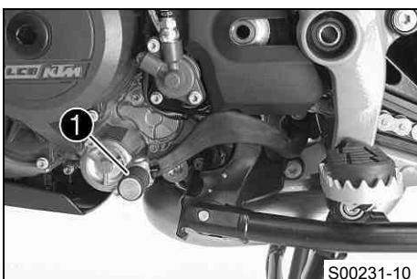
Řadicí páka ① je umístěna na motoru vlevo.
