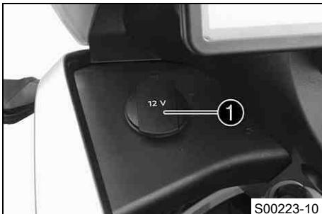
Zásuvka ① pro elektrické příslušenství je umístěna vlevo vedle sdruženého přístroje na palubní desce.
